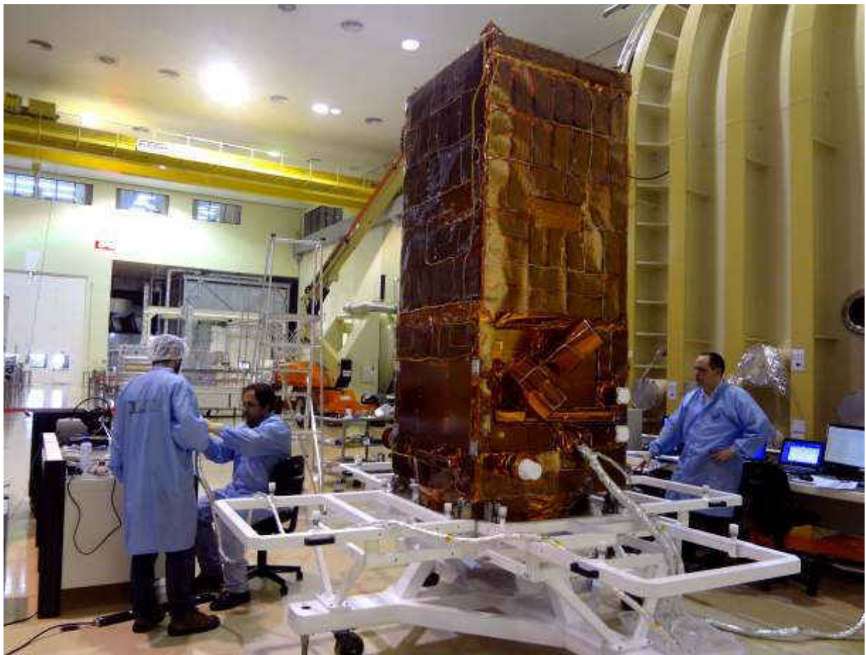
Modelo Térmico do Satélite Amazônia-1 sendo montado no Laboratório de Integração e Testes do Inpe/Inpe, 2015
