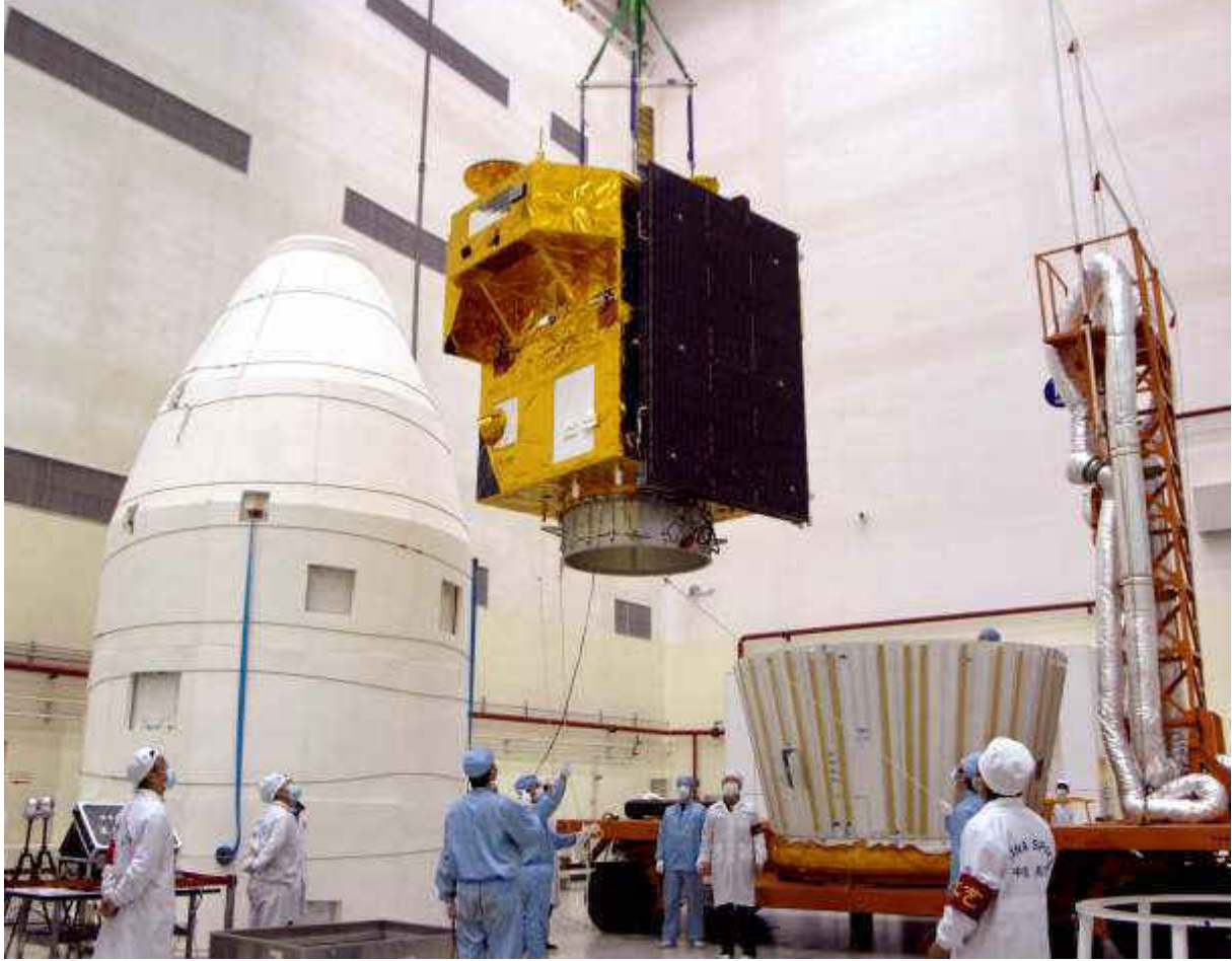
Satélite CBERS-4 sendo colocado na coifa de lançamento do lançador Longa Marcha-4B/Inpe, 2014
